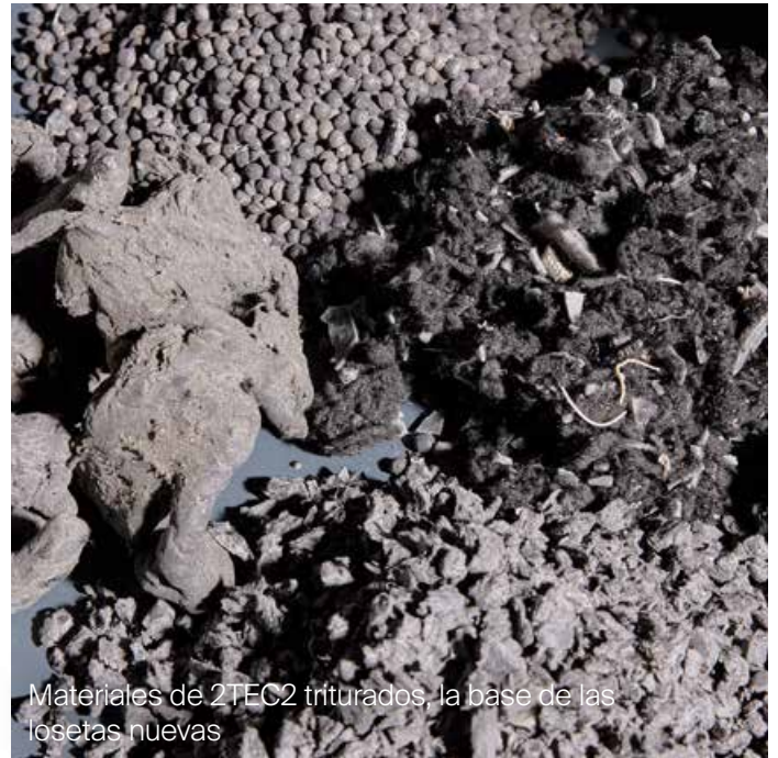
Residuos de 2TEC2 triturados para convertirlos en nueva materia prima
